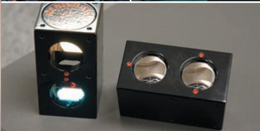
Εργαστήριο Διαστατικών | Σύστημα λέιζερ για την διακρίβωση του εργαλειομηχανών, μπχανών μέτρων συντεταγμένων και συστημάτων με κινούμενα μέρη ακριβείας.
